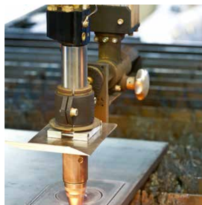
ALFA-Brenner mit integrierter Zündung und Abtastung ALFA torch with integrated ignition and height sensing
